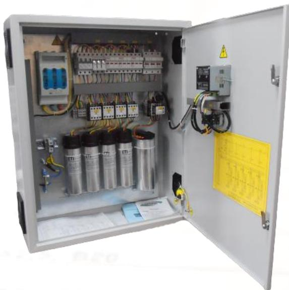
УКРМ-0,4 рекомендуется применять в сетях, где доля потребителей, загрязняющих сеть высшими гармониками, составляет менее 20% всех потребителей. Регулируемые установки компенсации реактивной мощности УКРМ-0,4 предназначены для поддержания постоянным заданного значения коэффициента мощности ( $\cos \phi$ ) в электрических распределительных трехфазных сетях промышленных предприятий и других объектов напряжением до 400 В, частотой 50 Гц.
