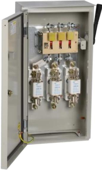
Ящики силовые с рубильником предназначены для нечастых (не более шести раз в час) коммутаций (ЯР, ЯРП) и ручных переключений основного и резервного ввода (ЯПР, ЯПРП) в цепях напряжением 380/220В трехфазного переменного тока частоты 50Гц с глухозаземленной нейтралью.
