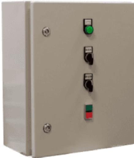
Ящики управления освещением ЯУО предназначены для автоматического, ручного или дистанционного (с диспетчерского пункта) управления осветительными сетями и установками производственных зданий, сооружений, территорий любых объектов с любыми источниками света (лампами накаливания, ДРЛ, ДРИ, люминисцентными и др.).
