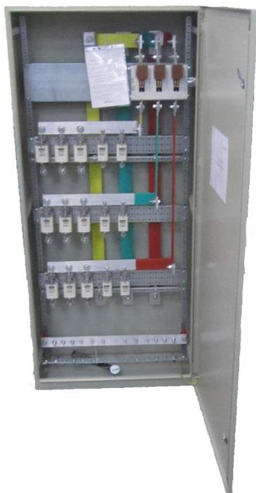
Шкафы силовые распределительные типа СПМ предназначены для приема и распределения электрической энергии трёхфазного переменного тока напряжением до 660В частоты 50Гц систем с глухозаземленной нейтралью, а также для защиты отходящих линий от перегрузок и токов короткого замыкания в промышленных установках.
