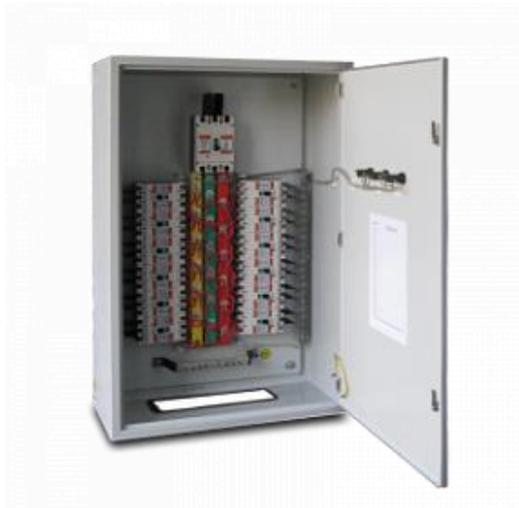
Пункты распределительные типа ПР11 предназначены для приема и распределения электрической энергии, защиты электрических установок напряжением до 660В переменного тока частоты 50Гц при перегрузках и коротких замыканиях, а также нечастых (не более 6-ти в час) включений и отключений электрических цепей и пусков асинхронных электродвигателей.
