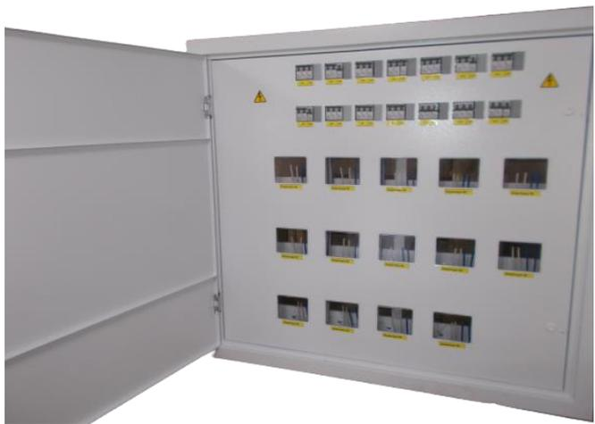
Щиты этажные предназначены для приема, распределения и учета электроэнергии переменного тока напряжением 230 В/ 400 В, 50 Гц, для защиты линий от перегрузок и токов короткого замыкания, а также для размещения устройств радиотрансляционной, телефонной и телевизионной сетей.
