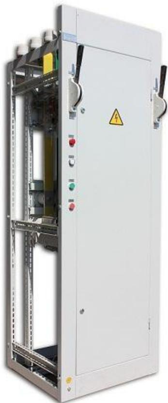
Панели распределительные серии ЩО 90(70) предназначены для приема и распределения электрической энергии трехфазного переменного тока частотой 50 Гц и защиты от перегрузок и токов короткого замыкания отходящих линий.
